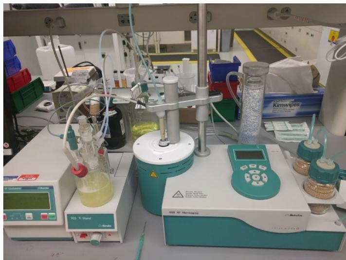
Figure 10. A 860 Thermoprep KF titration unit (Metrohm).
